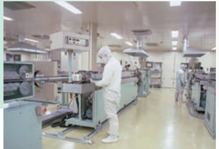
Clean room (tube processing)
